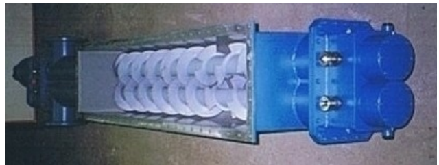
Einfülltrichter der DS-Doppelschnecke
